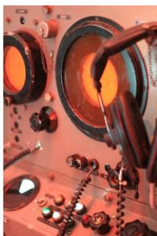
Le **sonar** est un système de détection fondé sur la réflexion des ondes sonores en **milieu marin**. Le système du sonar émet des impulsions ultrasonores et reçoit les ondes réfléchies par les obstacles.
