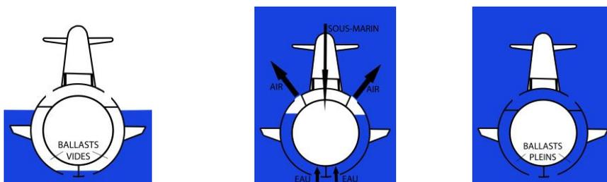
Lorsque les ballasts sont remplis d'eau, le sous-marin est à l'immersion périscopique entre deux eaux. Ensuite, c'est à l'aide des barres de plongée qu'il détermine son immersion. Les barres de plongée sont en quelque sorte des "ailerons" inclinables, placés à l'extérieur, de part et d'autres de la coque à l'avant et à l'arrière.
